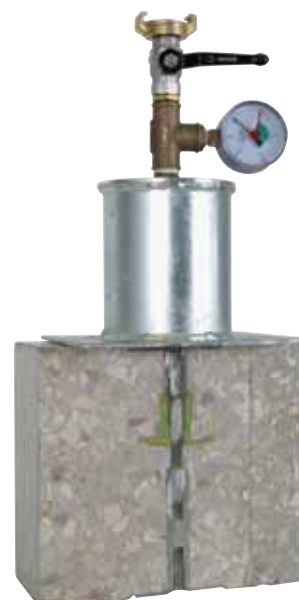
Prüfaufbau (Schnittbild) mit Anschluss für die Druckwasserprüfung
