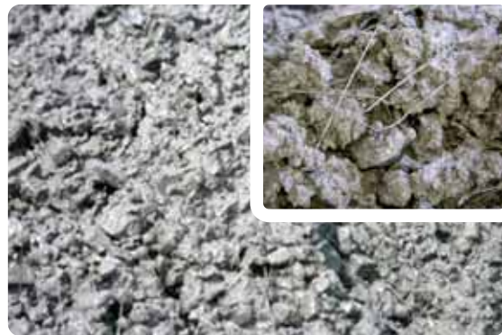
Frischbeton mit Stahlfasern Weitere Informationen unter www.vdsev.de
